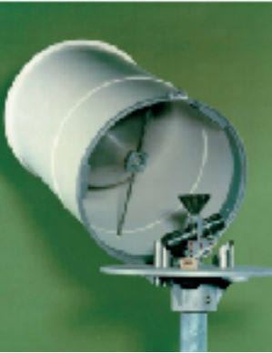
Figura 4. Veduta interna del pluviometro.
